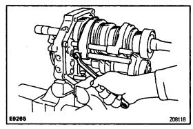
(d) Install the shift fork No.1 with a new bolt and torque the bolt.
