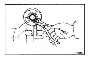
(d) Using a snap ring expander, install a new snap ring.
