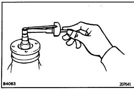
(d) Using a torque wrench, measure the preload.
